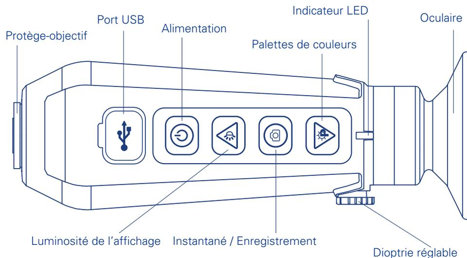
**Recharger la Scout TKx** : utilisez le câble USB fourni et connectez-le à une source d'alimentation. L'indicateur LED clignote durant le chargement et devient vert une fois le chargement terminé.
