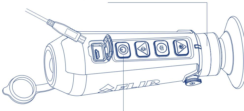
**Mise sous/hors tension** : appuyez sur le bouton Alimentation pour mettre votre Scout TKx sous tension. L'indicateur LED s'allume lorsque vous mettez l'appareil sous tension. Le logo FLIR s'affiche dans l'oculaire, suivi de l'image en direct. Pour mettre la caméra HORS TENSION, appuyez sur le bouton Alimentation et MAINTENEZ-LE ENFONCÉ. La caméra se met hors tension au bout d'une seconde.
