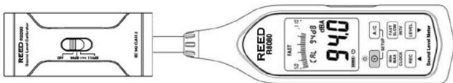
Pour étalonner le R8080, un étalonneur externe pouvant fournir un signal de 94,0 dB est requis (REED R8090). Si le sonomètre a été exposé à des
