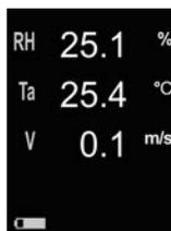
**Remarque:** Le point de rosée (Td) et la température de surface (Ts) ne sont pas affichés lorsque l'**anémomètre** est activé.
