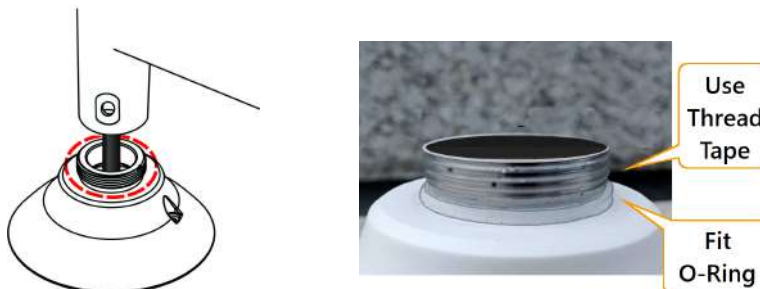
Waterproofing the Pendant Cap
