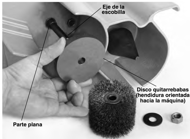
Figura 5 – Montaje del disco quitarrebabas
