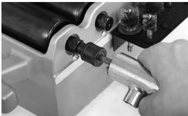
Figura 14 – Limpieza del interior de un acoplamiento
