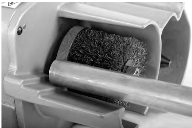
Figura 12 – Eliminación de rebabas del exterior del tubo
