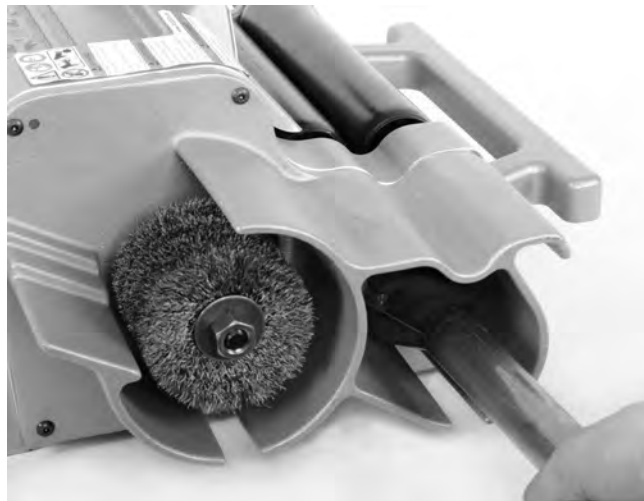
Figura 13 – Escariado del interior del tubo
